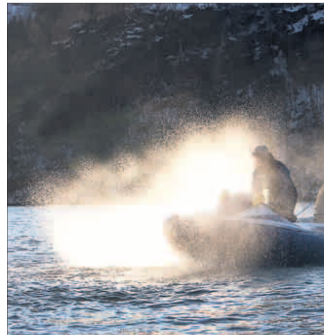
TIL GARDS PÅ LUFTPUTER: Ved hjelp av overtrykk held båten seg slevande underlaget, og kan forflytta seg både over land og vatn.
